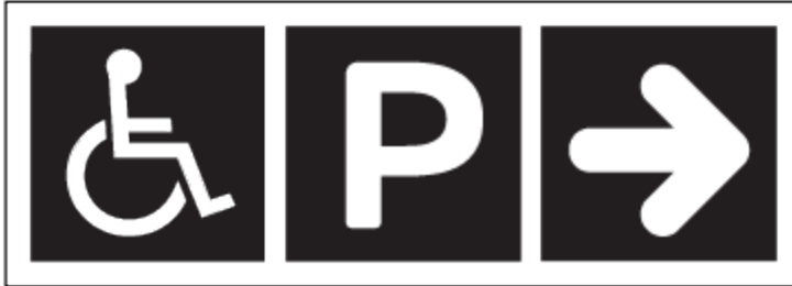
Figure [A-3.8.3.9. 3)-A] A-3.8.3.9. 3)-A Pictogrammes indiquant la direction des installations accessibles
