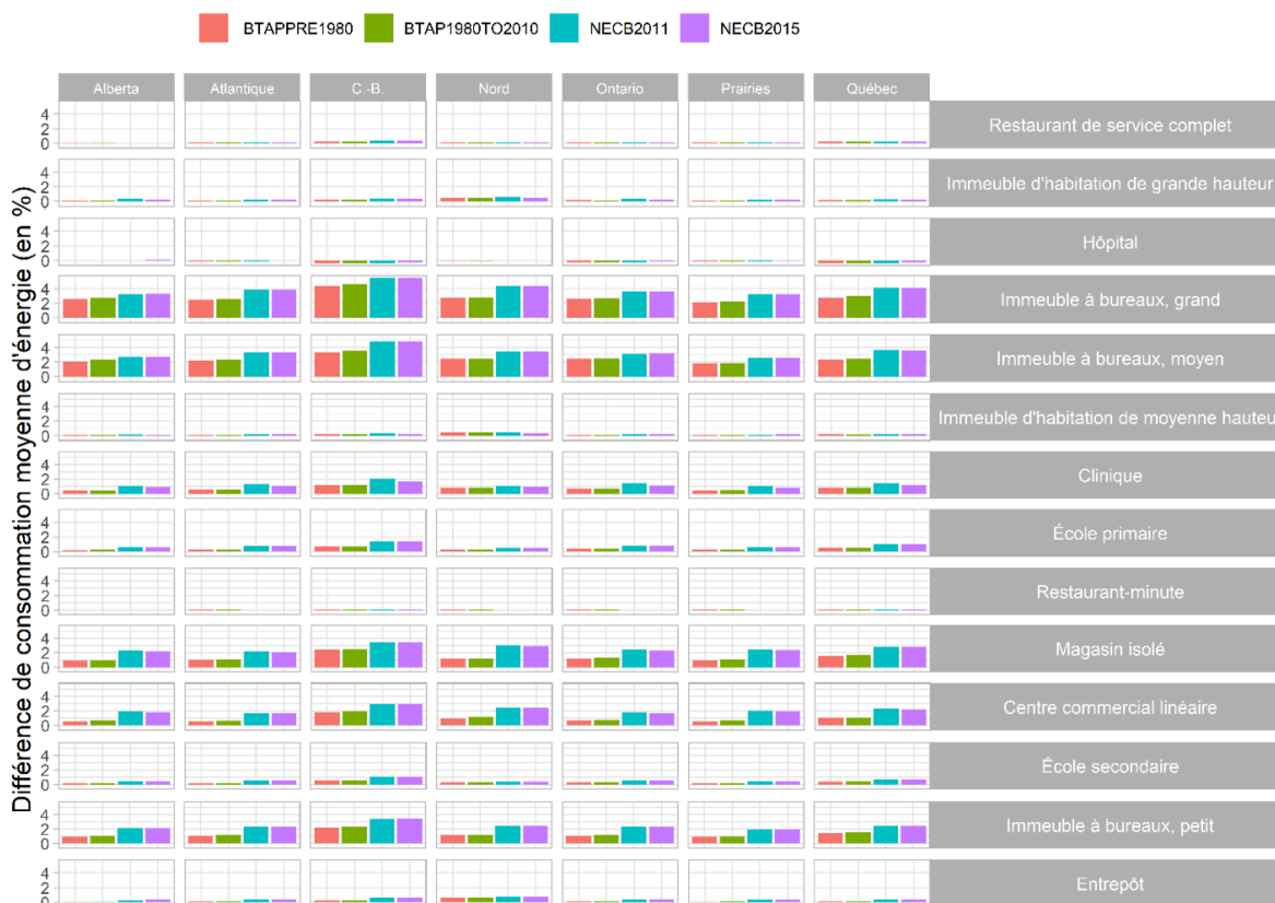
Figure 3. Différence marginale de l'intensité énergétique en pourcentage pour divers archétypes et versions de bâtiments dans différentes régions du Canada
